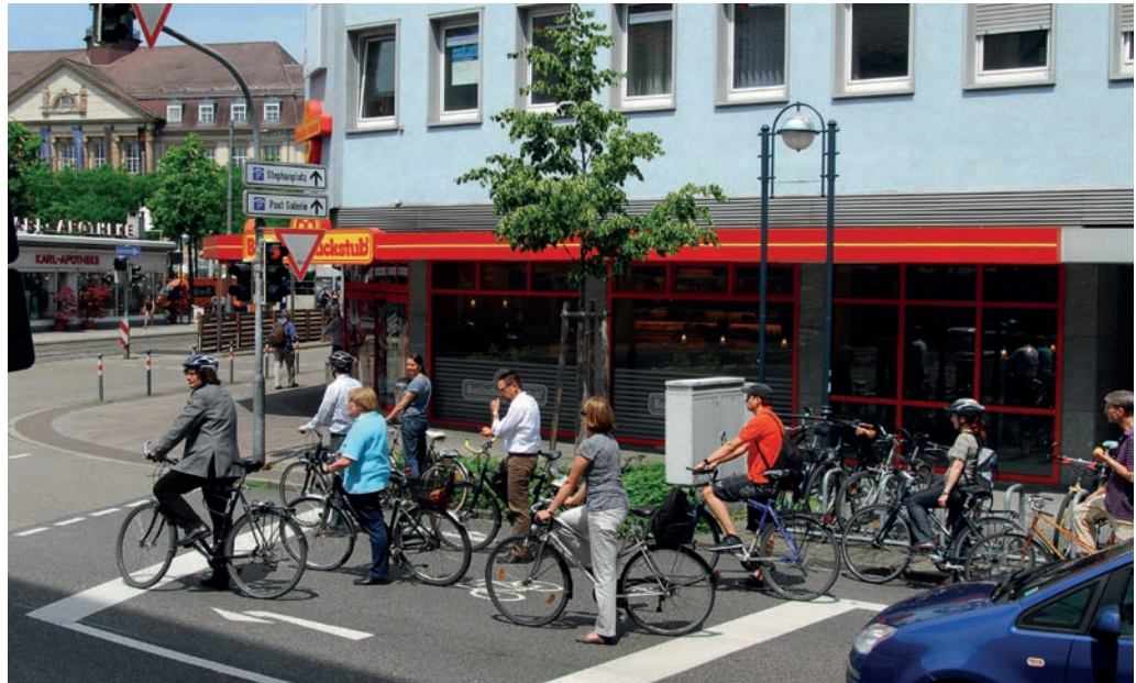
Aufgeweitete Radaufstellstreifen sichern Radfahrende in Knotenpunktzufahrten.
